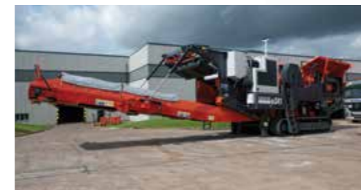
Гидравлический механизм подъема/опускания на главном конвейере увеличивает зазор
