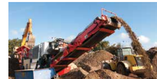
Длинный главный конвейер для формирования больших отвалов
