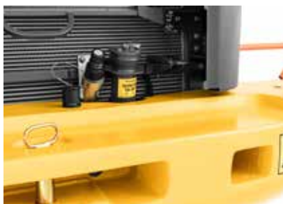
Система быстрой заправки топлива
